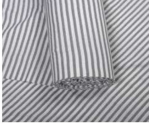
Şekil 6. İpliği boyalı kumaşlarda çizgi- çubuk efekti
