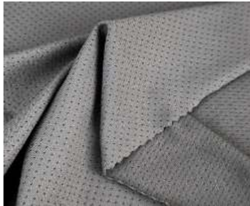
Şekil 7. İpliği boyalı kumaşlarda kuş gözü efekti
