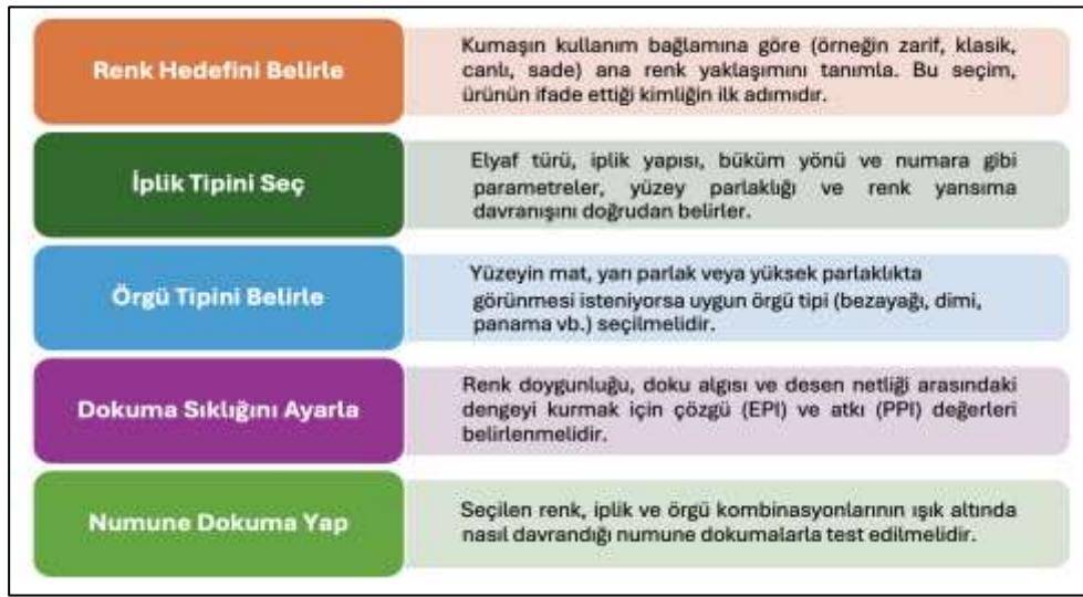
Şekil 11. İpliği boyalı gömleklik kumaşlarda renk planlaması sürecinde tasarımcının karar aşamalarını gösteren akış diyagramı (yazar tarafından hazırlanmıştır).
