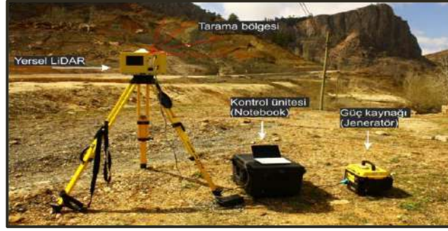
Şekil 4. 6 Yersel lazer tarayıcı (YLT) ve bileşenleri [75], [76]
