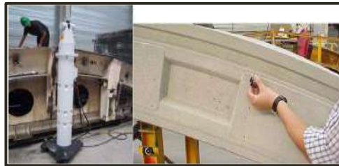
Şekil 4. 11 Segment kalıbı ve segmentlerin ölçümü [47]
