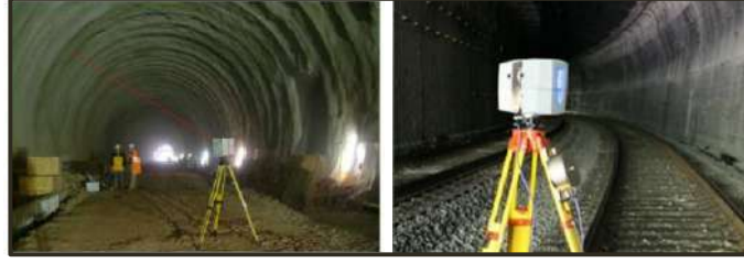
Şekil 4. 7 Yüksek çözünürlüklü YLT ve tünel taramaları [32], [80]
