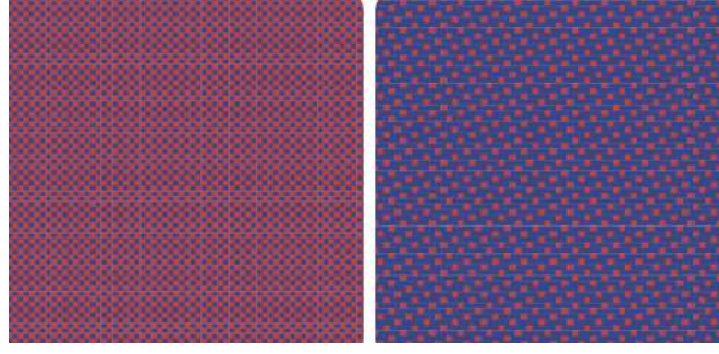
Şekil 3. Aynı renk ipliklerle dokunmuş bezayağı (sol) ve atkı sateni (sağ) örgü yapılarında yüzey düzeni ve yansıma farkının renk görünümüne etkisi. Bezayağı örgü sık bağlantı noktalarıyla daha mat ve düzenli bir yüzey oluştururken, saten örgü uzun yüzmeleri nedeniyle daha parlak ve doygun bir renk algısı yaratır (Mathur ve Seyam, 2000).
