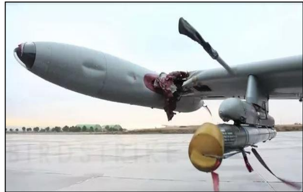
Şekil 20: Sağ kanat ucu yakıt tankı civarına çarpan kuşun meydana getirdiği hasar (Url-20).
