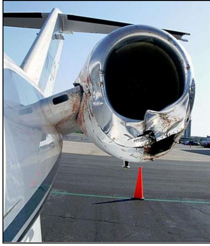
Şekil 14: Motor hava giriş menfezinde kuş çarpmasından kaynaklı hasar bölgesi (Url-14).
