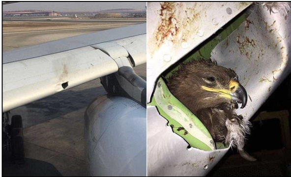
Şekil 19: Sol kanat ön flaplarına çarpan kuşun meydana getirdiği hasar (Url-19).
