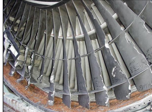
Şekil 16: Kompresör ön kanatçıklarında oluşan kuş hasarı (yakın görünüm) (Url-16).
