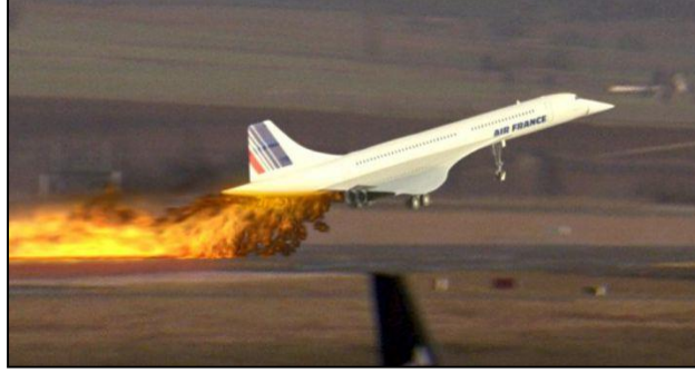
Şekil 5: Concorde uçağı, kalkışta motora emilen yabancı madde döküntüleri nedeniyle jet motorunda oluşan yangın (Url-7).
