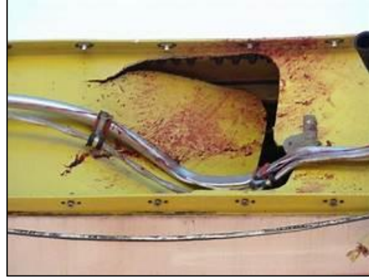
Şekil 18: Çarpışma sonunda hidrolik boruları delinebilir (Url-18).
