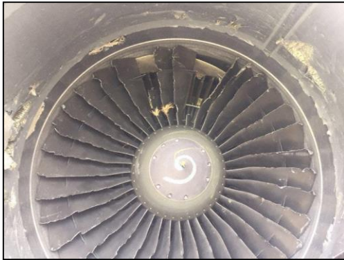
Şekil 15: Kompresör ön kanatçıklarında ve motor kaportasında oluşan kuş hasarı (Url-15).
