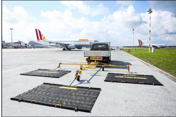
Şekil 30: Araç ile çekilen mekanik yatay süpürücüler (Url-24).
