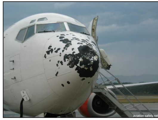
Şekil 13: Radom (konik koruyucu plaka) bölgesinde oluşan hasar (Url-11).
