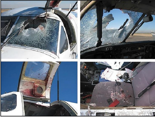
Şekil 12: Beech C-99 uçak ön camı ve kokpitte meydana gelen kaza (Url-10).
