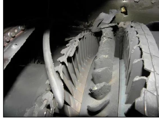
Şekil 8: Jet motorunun türbin kademelerindeki volkanik külün oluşturduğu hasar (Url-9).
