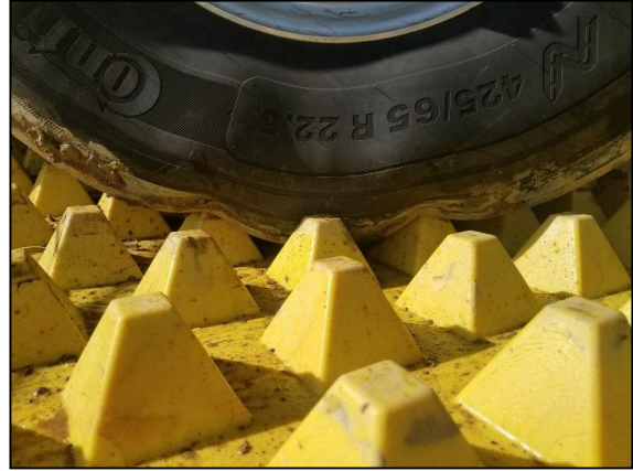
Şekil 3: Söz konusu yüzeylerdeki dişlerin şekli ve lastikle olan etkileşimi (Url-5).
