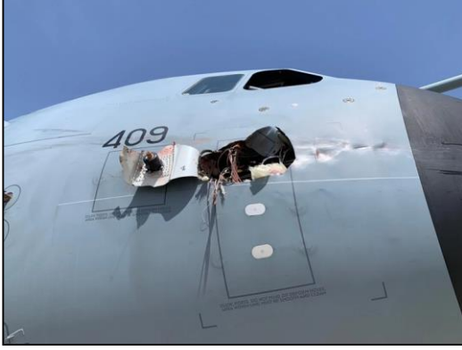
Şekil 17: Nakliye uçağının kokpit yanında oluşan çarpan kuş hasarı (Url-17).
