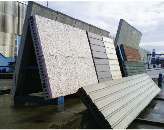
Şekil 7. Farklı doku ve modüllerde üretilmiş ön üretilmiş beton cephe panelleri (Gür, 2015)
