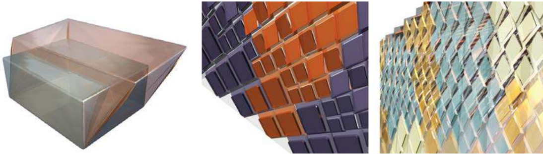
Resim 3.1.3. Gece ve gündüz kabuk elemanlarının genişleyip daralması ve kabuğu oluşturan farklı renklerdeki panellerin hareketi (Mazzoleni, 2010: 110)
